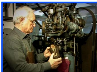
Bei der Schuhherstellung ..... der Schuhmacher das Oberleder über den Leisten, d.h., er ..... das Leder straff und ..... es dann fest, jeden Nagel einzeln. Die Oberlederzwickmaschine ..... die Arbeit.
