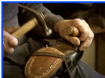
Das Besohlen eines Schuhs ..... früher eine langwierige Arbeit. Der Schuhmacher ..... Holznägel für Holznägel einzeln mit dem Hammer einschlagen. Mit der Holznägelmaschine ..... das viel schneller.
